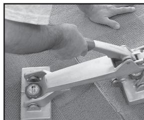
5. Alinee el diseño en el punto medio del largo de la costura. Trabaje desde el punto medio de la costura hasta los extremos. Haga coincidir el diseño usando el 10-128.
