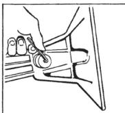
1. En el reverso del Estirador de Diseños hay un tornillo Allen negro que sujeta una arandela en forma de "copa" y el cabezal de potencia. Retire el tornillo Allen negro con la llave Allen provista.
