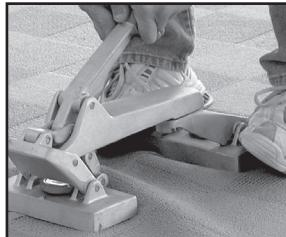
2. Use el dial del cabezal de agarre afelpado para ajustar correctamente la penetración de los pasadores y que tomen sólo el reverso de la alfombra y no el acolchado. Esto reducirá el riesgo de provocar daños a la alfombra y asegurará un correcto estiramiento.
