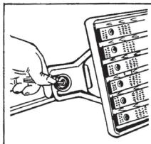
2. Retirez la rondelle cuvette et la tête mécanique.
