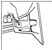
1. Il y a une vis Allen noire sous l'appareil de motifs qui maintient en place une rondelle « cuvette » et la tête mécanique. Retirez la vis Allen noire avec la clé Allen fournie.
