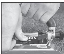
2. Dégager les dents et les positionner à l'ajustement voulu. Resserrer fermement les boutons.
