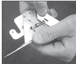
Enlever les vieilles lames tel qu'illusté. Insérer une nouvelle lame au-dessus de la pince à ressort et les guides surélevés. Lorsqu'un côté de la lame est non-tranchant, vous avez qu'à utiliser l'autre côté.
