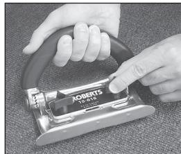
3.Inserte el soporte de la cuchilla sobre la placa. Ajuste la dimensión "hacia fuera y hacia dentro" según el tipo de alfombra que va a cortar. Hay 3 posiciones. Asegúrese de que ambos lados estén en la misma posición.
