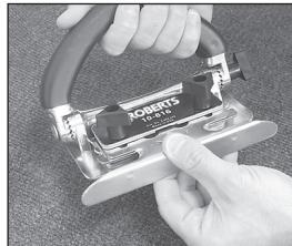
3. Insérer le porte lames au-dessus de la plaque de localisation. Ajuster le porte lame selon le type de tapis à couper. Il y a trois positions. S'assurer que la position des deux côtés de la plaque est la même.
