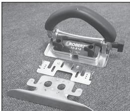
1.Tres partes básicas de su cortador: (de arriba hacia abajo) Cuerpo del producto, placa y soporte de la cuchilla.
