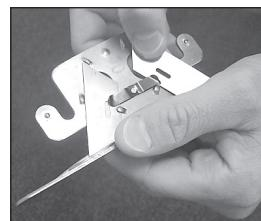
Cambie las cuchillas como lo indica el gráfico. Inserte la cuchilla nueva debajo del resorte. Cuando solo un extremo de la cuchilla esta sin filo, cambiela a la otra posición para doblar la vida de la cuchilla. Note: solamente use cuchillas ROBERTS en este cortador.
