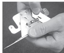
Cambie las cuchillas como lo indica el gráfico. Inserte la cuchilla nueva debajo del resorte. Cuando solo un extremo de la cuchilla esta sin filo, cambiala a la otra posición para doblar la vida de la cuchilla. Para obtener una mayor satisfacción, asegúrese de que pueda leer lo impreso en la cuchilla una vez que este en su posición para ser usada.
