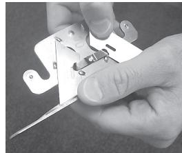
Enlever les vieilles lames tel qu'ilustré. Insérer une nouvelle lame au-dessus de la pince à ressort et les guides surélevés. Lorsqu'un côté de la lame est non-tranchant, vous avez qu'à utiliser l'autre côté. Conseil: Lorsque la lame est dans la bonne position vous devriez être capable de voir l'écriture sur la lame.
