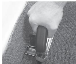
2. Rester la plaquette pour la base sur le tapis à plat et déplacer la guide contre le mur et couper le tapis.
