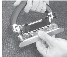
4. Ajuste las perillas firmemente para asegurar el soporte de la cuchilla.
